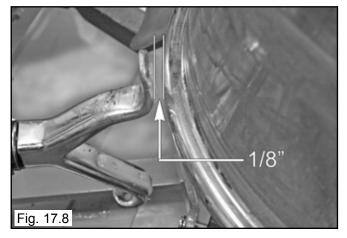
NOTE: THE TOOL HEAD IS ADJUSTED FROM THE FACTORY SO THAT THE TAB SIDE OF THE TOOL HEAD WILL BE 1/8" FROM THE RIM EDGE WHEN PUSHING AND HOLDING THE Target Lock™ BUTTON ON THE TOOL HEAD JOYSTICK CONTROL. THE HOOK SIDE WILL BE SLIGHTLY FARTHER AWAY FROM THE RIM EDGE.
