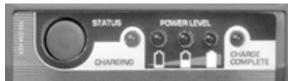
Gráfico 2. Botón de prueba, indicadores LED de carga en curso y unidad cargada
